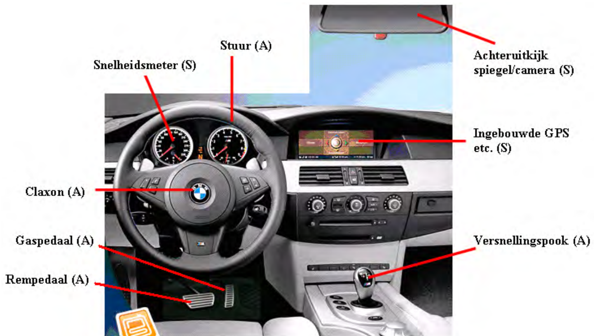
Figuur 22: Enkele actuatoren (A) en sensoren (S) van het taxi agent-systeem in de taxi.
