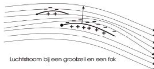
Fig 1.4.3: Luchtstroom bij zeilschip dat zowel fok als ook grootzeil heeft (bron: [2]).
