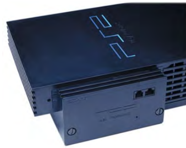
Fig. 10 De plek waar de ethernetkaart op de PS2 wordt bevestigd.
